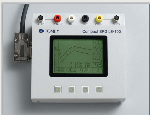
操作・電極接続部
